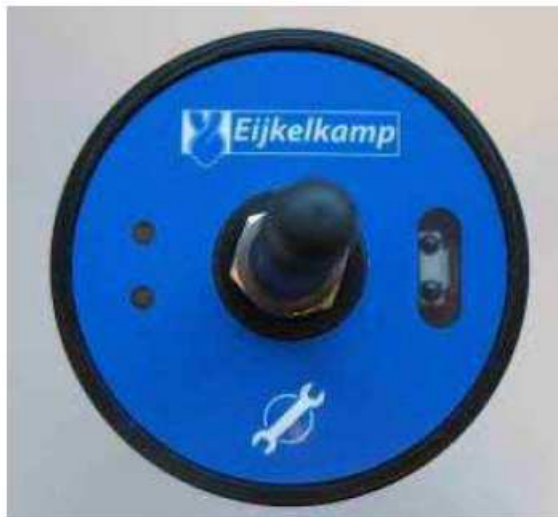
Armaturna plošča (ključ za vijake), IrDA (desno), LED indikatorji (levo: rdeča LED zgoraj, zelena LED spodaj) in antena (v sredini).
