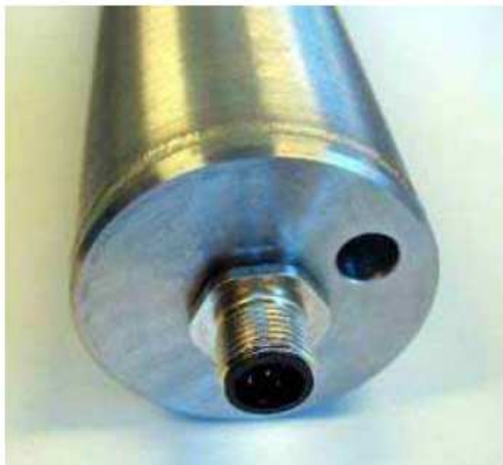
Priključek za priklop enega senzorja (e+ senzor, Diver® ali analogni senzor)
